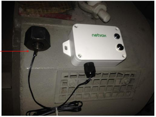
本产品自带防水功能。使用时可将其背面吸附于铁质表面上,或者使用螺丝将其两端固定于墙面。注:安装电池请使用一字螺丝起子之类的工具辅助打开电池盖。
